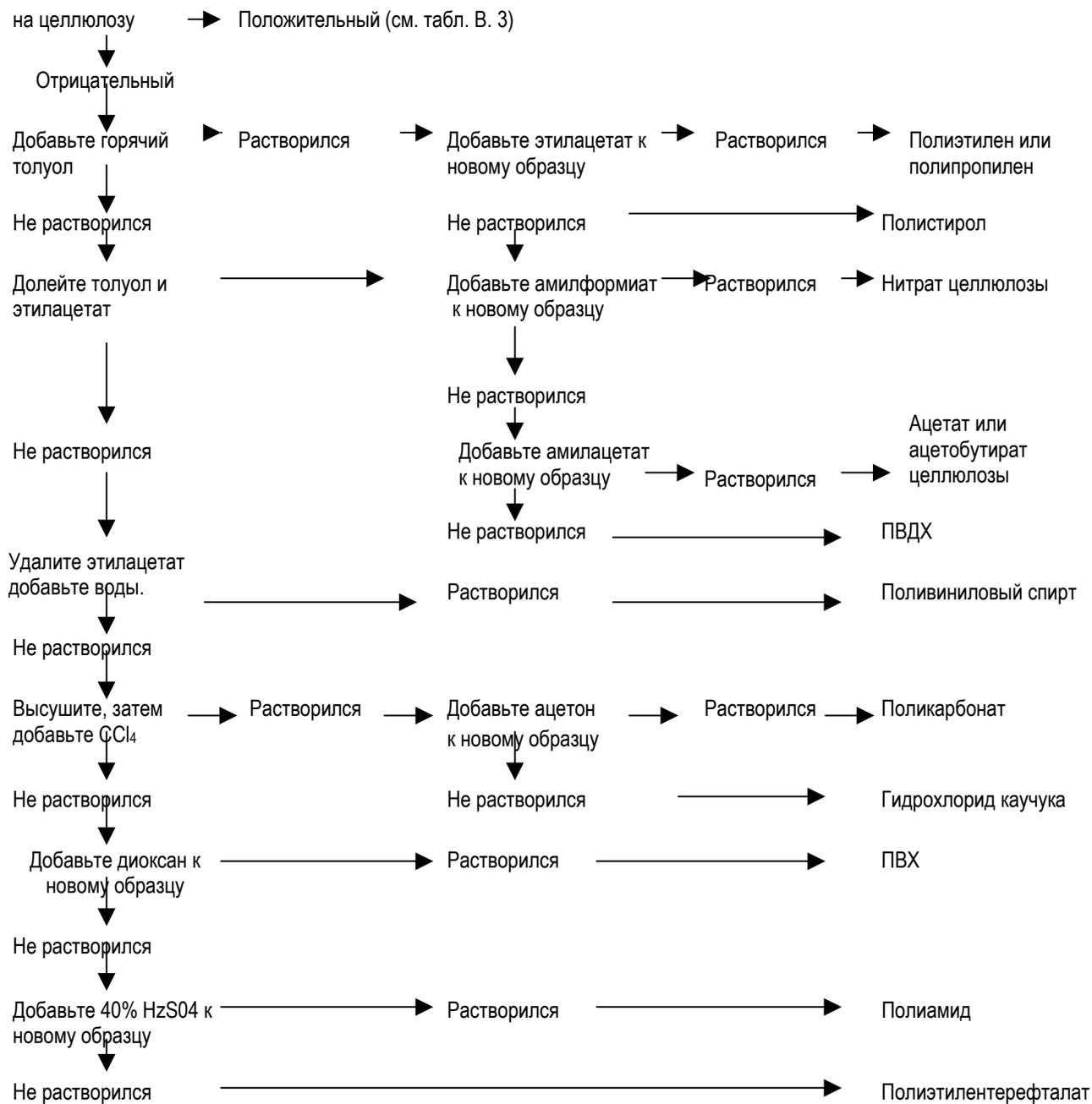
Рис. В.1. Определение полимера пленки по растворимости
